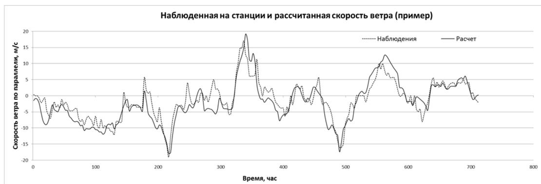
**Рисунок 25. Наблюденная на станции и рассчитанная по модели скорость ветра**
